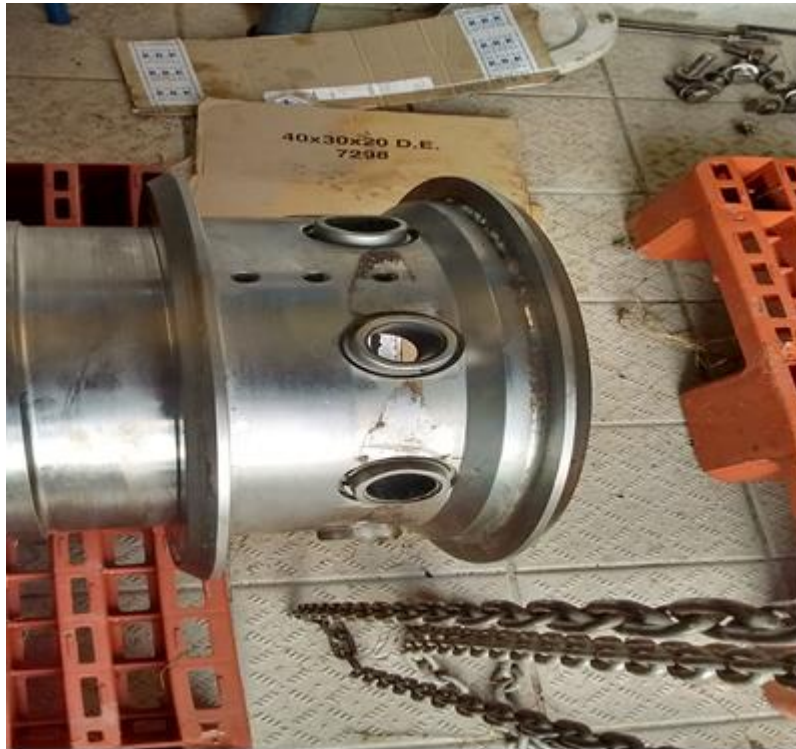
Figure2 : Renouvellement des buses du bol de la centrifugeuse
