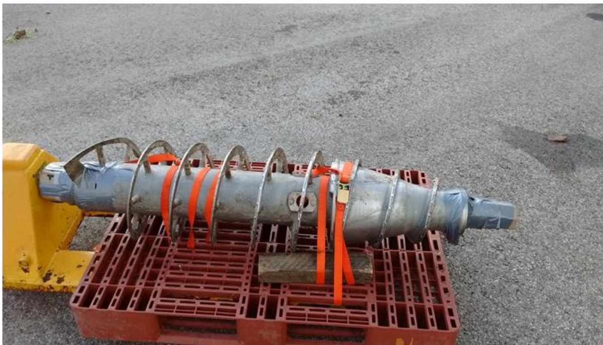
Figure 3 : Révision de l'équilibrage de la vis d'une centrifugeuse en atelier
